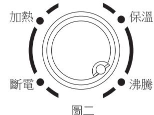
3. 若旋鈕從斷電處直接旋轉到圖三處，產品通電加熱到該處的溫度後自動斷電，若鍋體中的水已經沸騰，再把旋扭轉到圖三處，則產品斷電，指示燈熄滅，產品停止，待鍋體中的水溫降至該處溫度後，產品將自動重新加熱。
