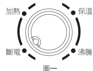
2. 旋鈕指到沸騰處，如圖二，產品通電時，指示燈亮而且加熱，此時產品不能自動斷電。
